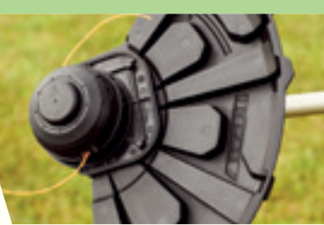
Le coupe-bordures est doté de la technologie « tap and go ». Le fil est réajusté automatiquement pendant le fonctionnement en frappant la tête faucheuse au sol
